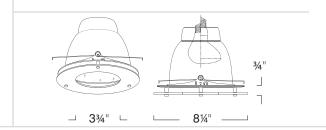
REMODEL SHALLOW HOUSING LH27RICA 120V 90W Max A19/PAR30/PAR38 MED E26
