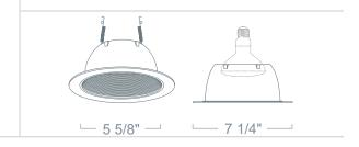
**100W IC HOUSING** 120V 100W Max R30/PAR30/PAR38/A19 MED E26
