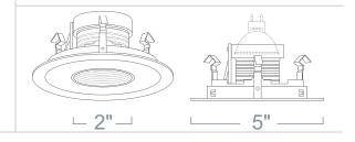
**NEW CONSTRUCTION LH99MH-GX10** *HID 20W/39W MR16 GX10*
