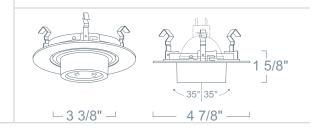
SHALLOW IC HOUSING **LSH1499IC** 12V Out 37W Max MR16
